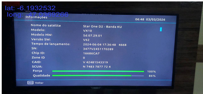
FOTO - VALIDAÇÃO: NÍVEL DE SINAL, CONFIRMAÇÃO D2 (70)W E VERSÃO DE SOFTWARE, NUMERO DO
